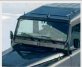
Eine Campingsteckdose und Solarzellen sorgen für Stromnachschub im Stand.
