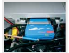
Die im Server fest verbaute Mobile Unlimited-Karte von Swisscom Mobile ermöglicht den nahtlosen Wechsel zwischen WLAN, UMTS und GPRS und später Edge – auch im Ausland.
