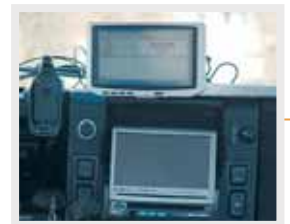
Die berührungsempfindlichen Monitore lassen sich auch während der Fahrt mit den Fingern bedienen.
