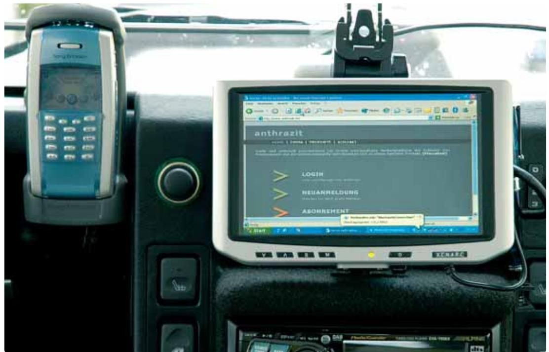
Mobile Breitbandssysteme machen es möglich, von unterwegs auf den Server in der Firma oder zu Hause zuzugreifen oder im Internet zu surfen. Das ist im Mobile Broadband Car nicht anders als bei einem Notebook, das über eine UMTS- oder eine WLAN-Karte verfügt. Neu am Mobile Broadband Car ist die Art und Weise, wie diese Inhalte im Fahrzeugcockpit abgerufen und zur Verfügung gestellt werden.
