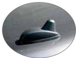
Diese Antenne deckt den Bereich von 2,5 GHz ab – also WLAN. Über diese Antenne kann sich der Autocomputer in Hotspots einklinken. Sie ist eine Verlängerung der Antenne des Computers, damit die Fahrgastzelle nicht voller Funksignale ist.
