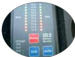
Das Steuergerät für die Doppelbatterie überwacht das Laden der Batterie und den Stromverbrauch. An Bord befinden sich zwei 100-A-Batterien. Das Steuergerät zeigt den Ladezustand der Batterien an und kann auf Wunsch beide Batterien zusammenschalten und so die Leistung verdoppeln.
