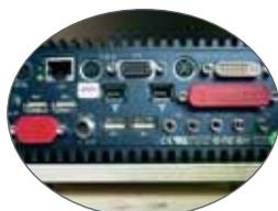
Das Hirn des Mobile Broadband Car besteht aus einem marktgängigen Mini-computer. Die Stromversorgung hat 12 Volt. Der Computer arbeitet ohne Lüfter und übersteht es auch, wenn er mal durchgeschüttelt wird.
