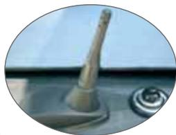
Eigentlich war die GSM-Antenne auf der Kühlerhaube als kombinierte Radio-GSM-Antenne gedacht, die Kombination hat sich jedoch nicht bewährt. Der Mobile Broadband Car hat deshalb für den Radioempfang eine separate, zweite Antenne.
