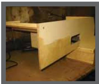
Der Serverraum. Das Gerüst ist aus Modellbauerspertholz gebaut. Eingebaut ist der Serverraum hinter der linken hinteren Türe. Der Serverraum nimmt den Computer und die zentralen Elektronikbauteile des Mobile Broadband Car auf.
