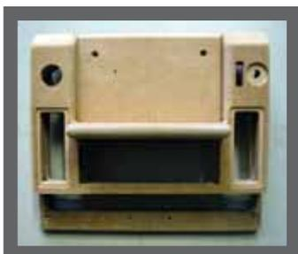
Das ursprüngliche Armaturenbrett der Mittelkonsole wurde entfernt und durch eine Holzkonstruktion ersetzt. In der Mitte wird der Bildschirm platziert, die Löcher dienen der Aufnahme der ursprünglichen Schalter etwa für die Ventilation.
