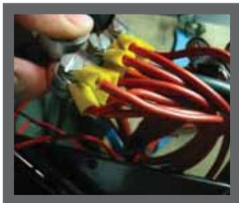
Das Stromkabelsystem musste erweitert werden. Im Landrover ist jetzt eine Doppelbatterie eingebaut: Eine Batterie für den Anlasser, eine zweite für die Elektronik. Im Auto stehen nicht nur 12 Volt, sondern 220 Volt zur Verfügung.
